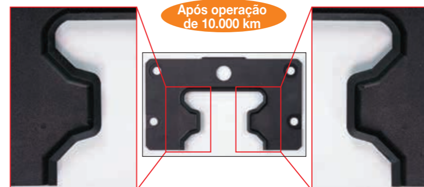
Condição de desgaste da borda da vedação de extremidade
