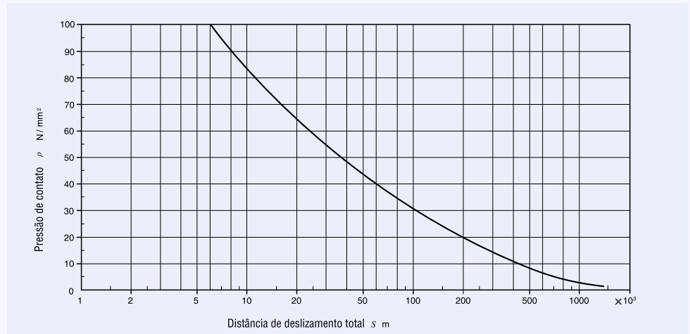
Fig.5 Distância de deslizamento total contra a pressão de contato das Buchas esféricas livres de manutenção
